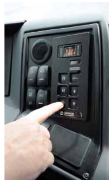
U automatu chybí nejen spojka, ale i řadič páka. Pohyb vpřed nebo vzad se volá tlačítky na přístrojové desce.
