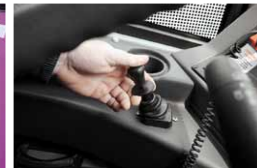
Přitáhnutím kroužku a pohybem vpřed se autobus odbrzdí
