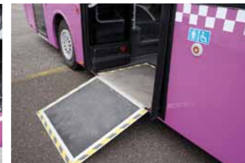
Rampa pro hendikepované je součástí základní výbavy
