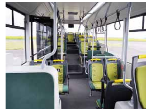
Podlaha v prostoru pro cestující se zvedá vzhůru jako v divadle, aby se pod zadní sedadla vešel pohodlně motor
